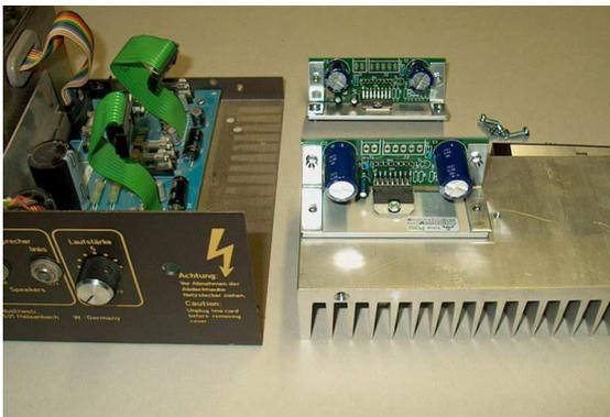
Lösen Sie die Transportmuttern auf der Rückseite des Distanzkühlkörpers. Montieren Sie mit den verbleibenden Schrauben den Power-Booster DX auf den Kühlkörper.
