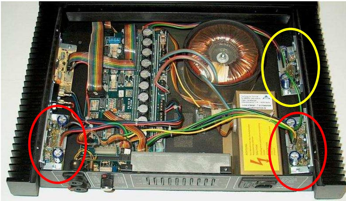
Die von uns gelieferten Booster haben auf der Rückseite des Aluminium- Distanzkühlkörper zwei 4mm Mutter. Diese sind nur für Versandzwecke montiert. Lösen Sie die Muttern und montieren Sie die verbleibenden 4mm Schrauben des Distanzkühlkörper an der Stelle des ehemaligen Hybridverstärkers OM 961. Die Abstände sind exakt die gleichen. Eine Änderung auf der Gundplatine ist nicht nötig, der Booster ist 100% Kompatibel.
