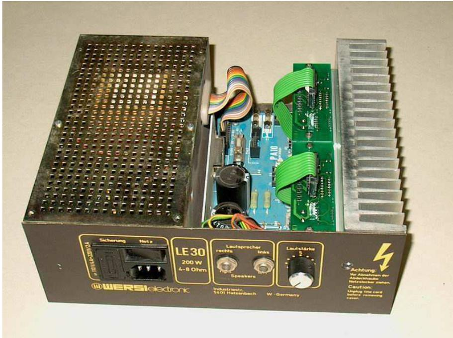
Die Abbildung links zeigt den kompletten Leitungseinschub LE30 mit den neuen Power-Booster DX.
